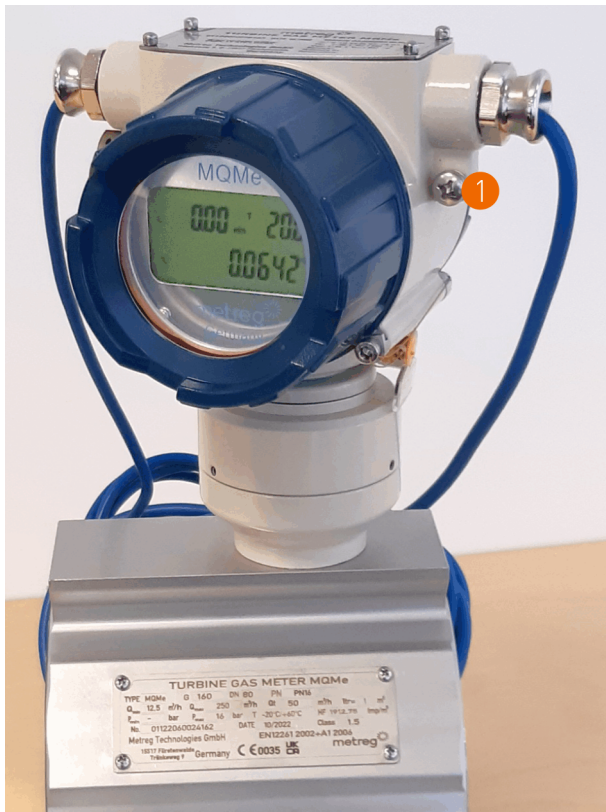
Abb. 4 Anschluss des bauseitigen Potenzialausgleichs
